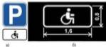
Рисунок 55 – Пример обозначения машино-места для стоянки (парковки) транспортного средства инвалидов использованием дорожных знаков (а) и дорожной разметки (б)
